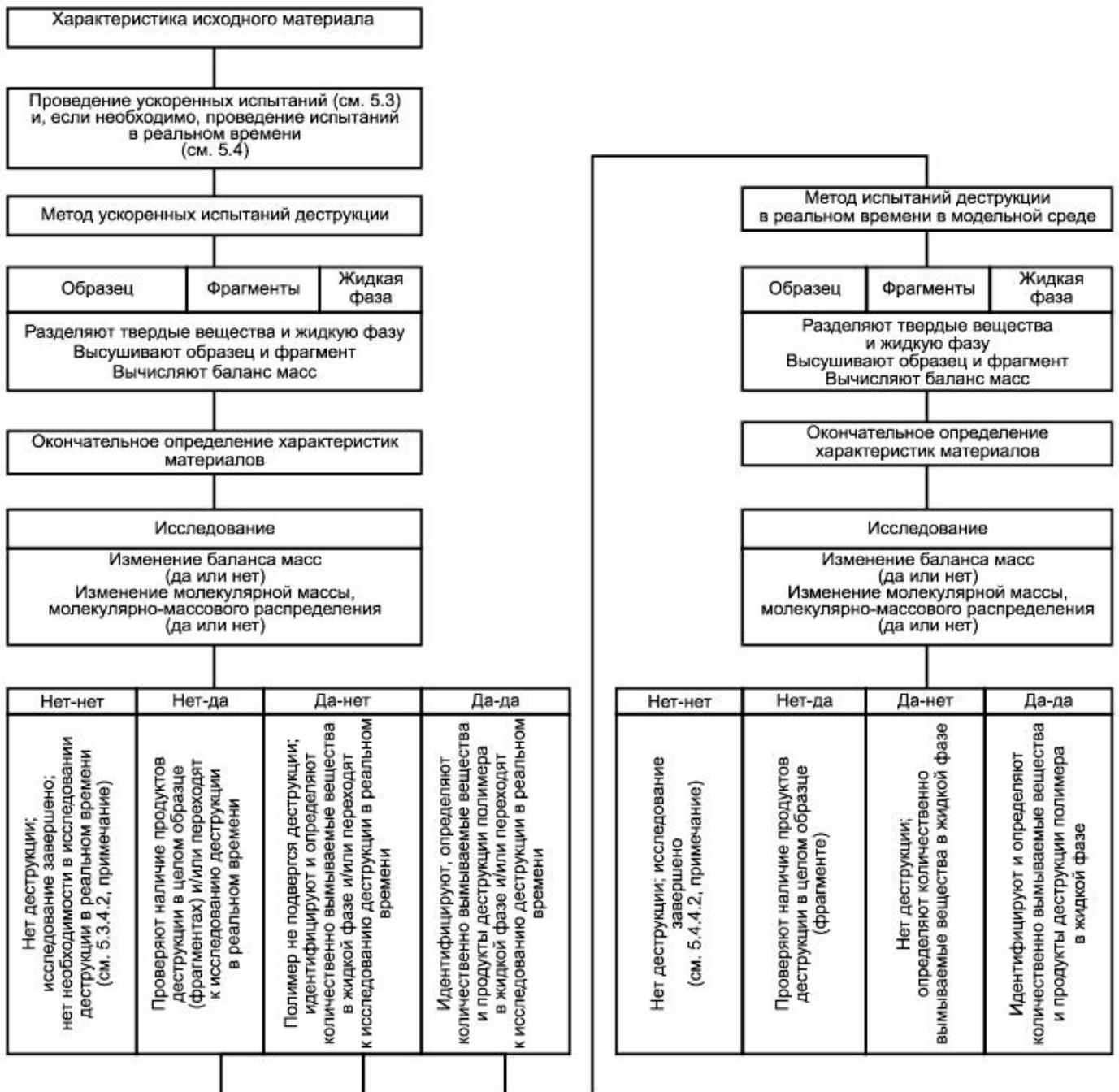
Рисунок 1 - Блок-схема процедуры испытаний
